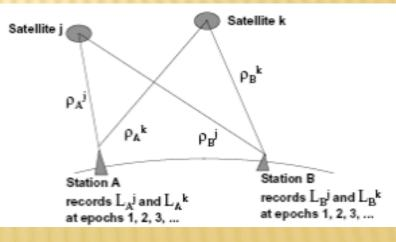
$\nabla \Delta L_{AB}^{jk} = \Delta \rho_{AB}^{j} - \Delta \rho_{AB}^{k} + \Delta c \tau_{AB} - \Delta c \tau_{AB}$  $+ \Delta Z_{AB}^{j} - \Delta Z_{AB}^{k} + \Delta I_{AB}^{j} - \Delta I_{AB}^{k} + \Delta B_{AB}^{j} - \Delta B_{AB}^{k}$
